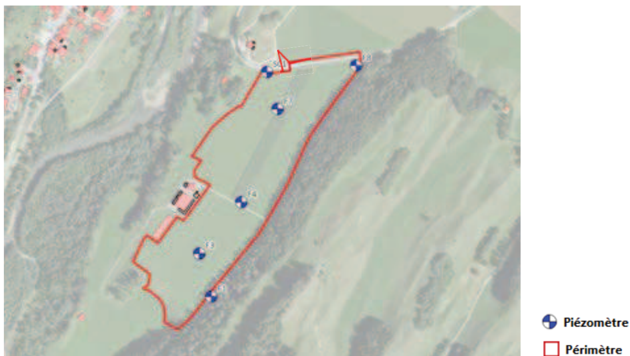
Figure 5-9 Implantation des piézomètres dans le périmètre d'exploitation et à proximité.
